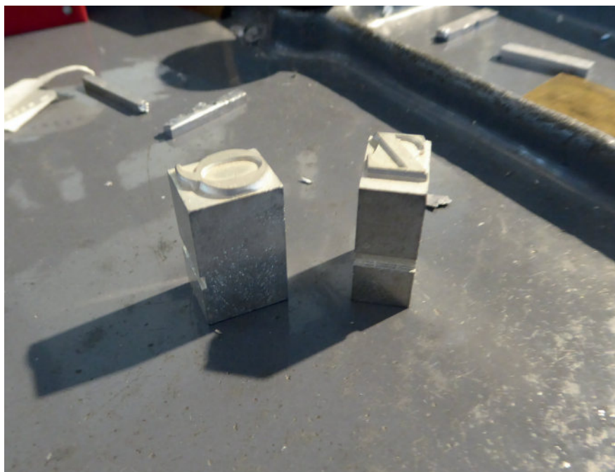
Monotypesats. De løse typene gjorde at det kunne blandes med håndsats. For setteriene var det også mulig å bruke Monotypeanlegget til å støpe typer og blindmateriell. Museum der Arbeit.
