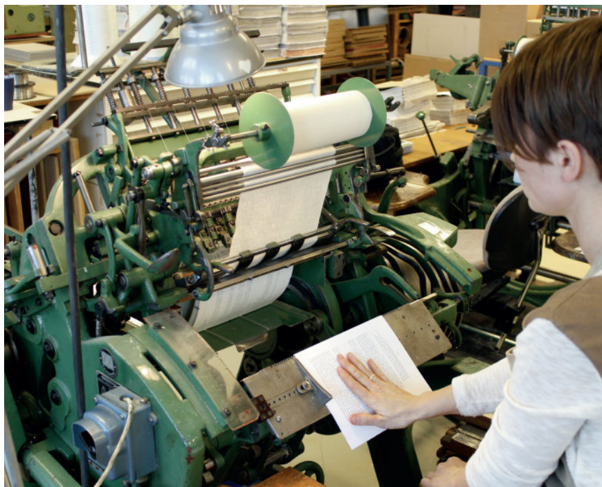
Hefting av bokblokk, ett og ett ark legges inn og syes på plass i denne maskinen. Kristine, klubbleder på Ørenbergs bokbinderi, demonstrerer.
