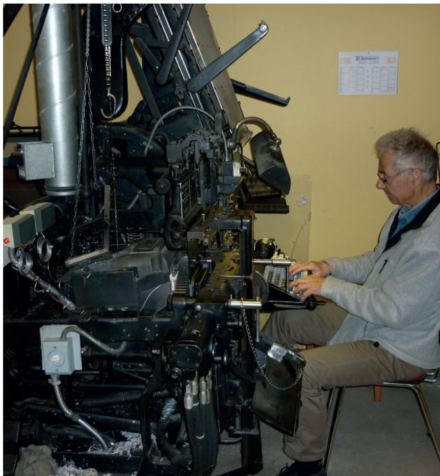
Maskinsetter Tore Vestli ved Linotype settemaskin i Strømmen Snartrykk. Den kanskje siste settemaskinen som var i jevnlig bruk hos oss. Tore arbeidet ved maskinen minst en gang i uken frem til bildet ble tatt i 2010.
