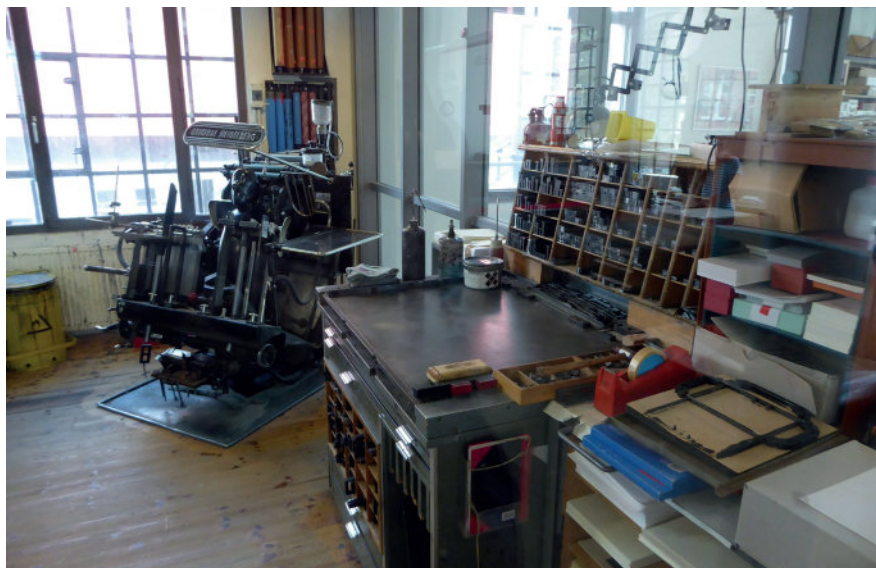
Et typisk boktrykkeri. En Heidelberg Vinge, en av de vanligste maskinene i et trykkeri. I forgrunnen trykkerens arbeidsbord der arbeidet med formen og forberedelse til trykking finner sted. Museum der Arbeit.
