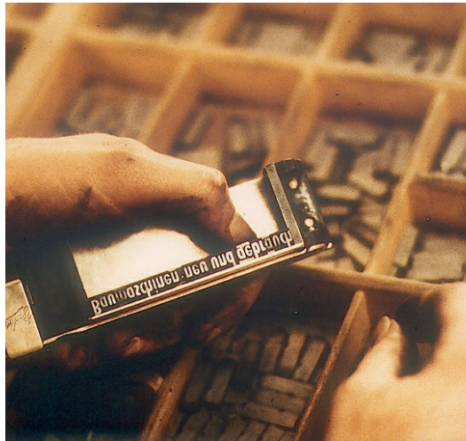
Nærbilde av setterens arbeid. Høyre hånd plukker typene fra kassen, vinkelhaken holdes i venstre hånd og tommelen holder typene på plass. Bilde fra avisen Submissions-Anzeiger på 1970-tallet. Foto: Submissions-Anzeiger
