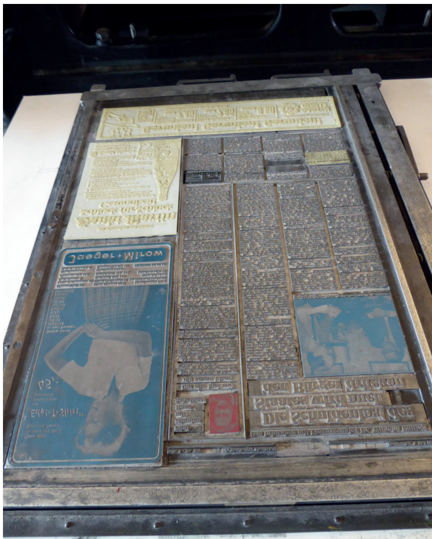
En ferdig side. Denne er ment for stereotypering - fargene er nok lagt til for at det skal være visuelt på museet. Vi ser sats og klisjéer, men også litt av matrisepappen (hvit) for å synliggjøre hvordan pregingen fungerte. Museum der Arbeit.
