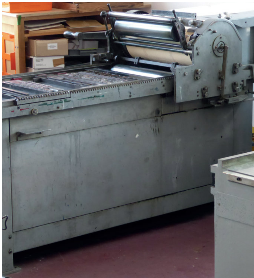
Korrekturpresse. Denne pressen er spesiallaget som korrekturpresse. Det var ellers ikke uvanlig at det ble brukt eldre håndpresser til korrekturtrykk i mange trykkerier. Museum der Arbeit.
