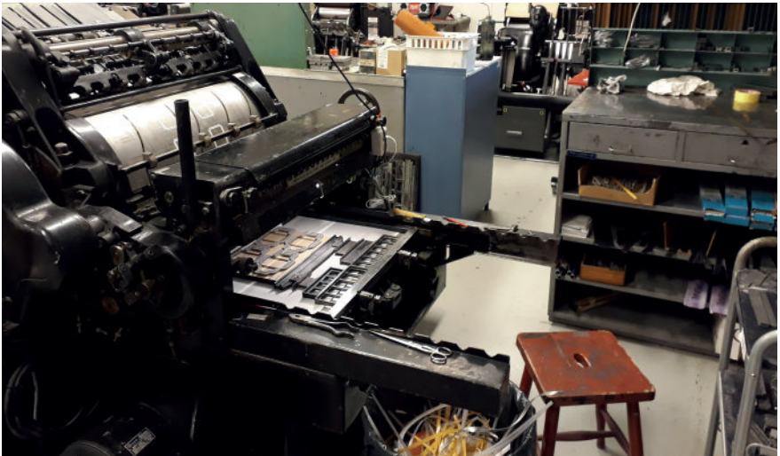
Heidelberg sylinder. Selv om det er slutt på boktrykking er det mange slike maskiner i drift over hele verden. Denne brukes til stansing på Fagtrykk i Trondheim. Bildet er tatt 22. November 2018
