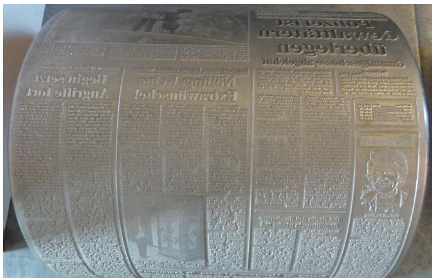
Stereotypert form. Nå er den klar til å spennes inn i trykkmaskinen. Museum der Arbeit.
