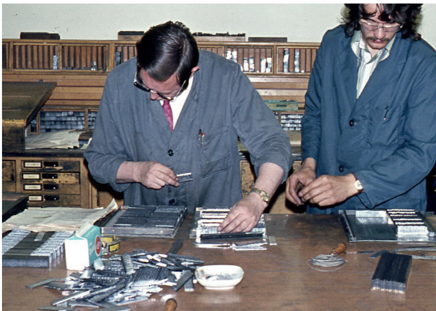
Ombrekking av linjestøpt maskinsats, Tyskland 1972.
