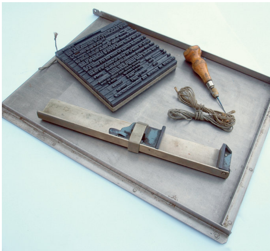
Setterens viktigste verktøy; vinkelhake, ål, kolumnesnor og ferdig innbundet sats. Alt plassert på et skiff. Foto: Wilhei - Wikipedia
