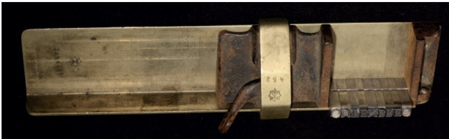
Vinkelhake. Satsbredden kan justeres og satsen måtte fylle helt ut på linjen.
