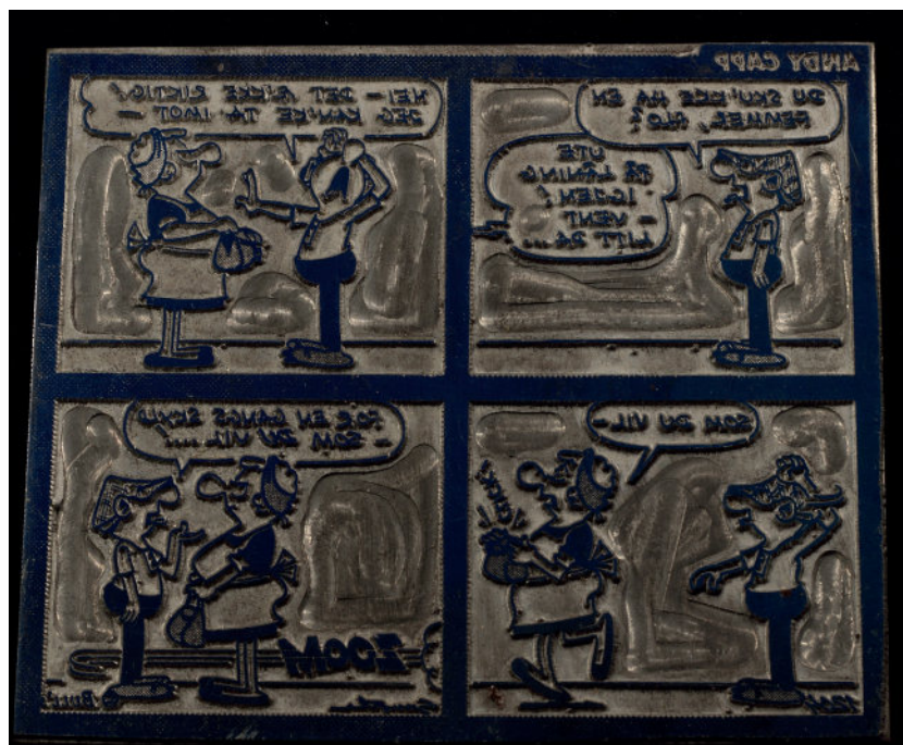
Zinkklisje - den er tydelig brukt for å trykke blå farge. Sporene etter fresemaskinen synes tydelig.
