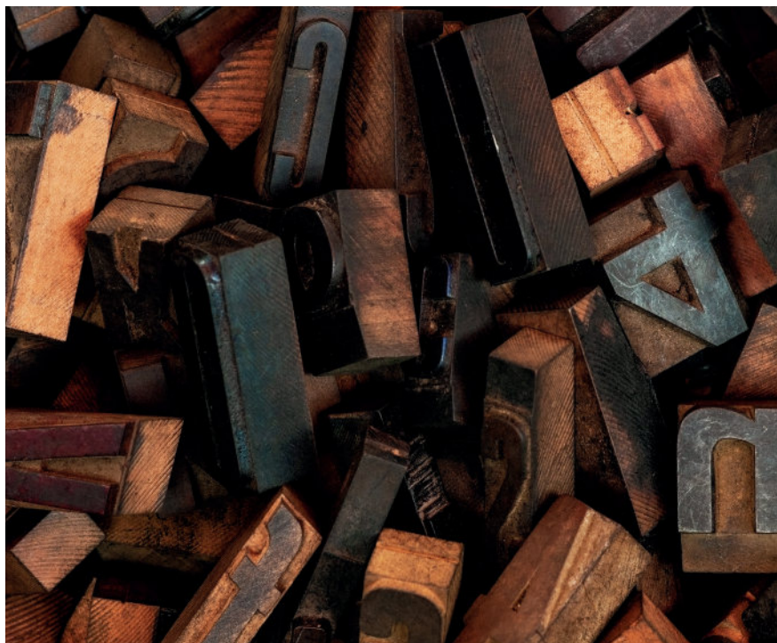
Tretyper. Når det skulle brukes store bokstaver ble det ofte brukt bokstaver av tre. Foto: Michele M. F - Wikipedia.
