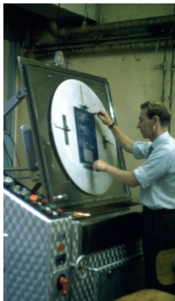
Klisjefremstilling, Aktietrykkeriet på 1970-tallet. Det er nok skritt 19 og 20 som her foregår i en maskin. Foto: Aktietrykkeriet
